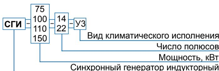
ТЕХНИЧЕСКИЕ ПАРАМЕТРЫ ГЕНЕРАТОРОВ СГИ
