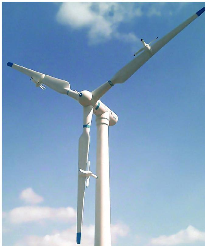
Ввиду оригинальности конструкции ветровой установки (расположение генераторов на лопастях) генераторы подвержены при эксплуатации значительным перегрузкам - до 13g длительно и до 16g кратковременно (до 5 минут), при этом сохраняют работоспособность и характеристики, что обеспечивается их конструкцией.
